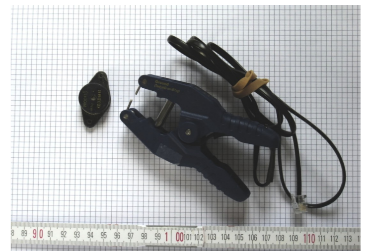
Les capteurs thermiques ont la forme de boutons d'environ 2 cm de diamètre. Leur mise en place sur le toit peut souvent se faire depuis l'intérieur mais nécessite parfois de s'aventurer sur le toit. (Photo Natura)
