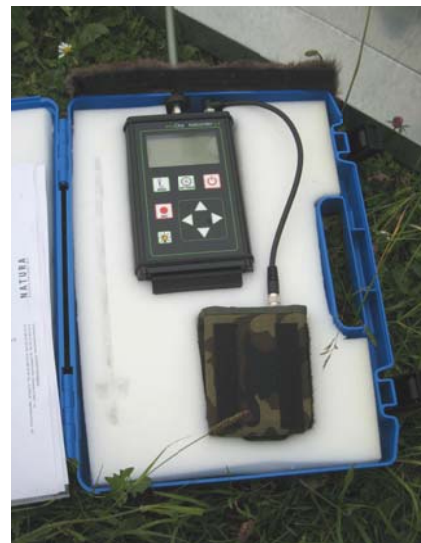
Le coffret de protection. En bas, l'accu, relié par un câble au détecteur. En haut, fixé à l'extérieur du coffret, une « peluche » destinée à éviter que l'écho des ultrasons sur le coffret ne crée des interférences.
